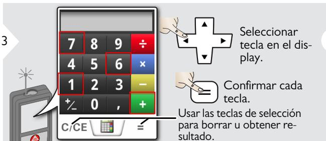
**i** El resultado de medición de la línea principal se transfiere a la calculadora y puede usarse para otros cálculos. Ft/in fraccional se convierte en ft/in decimal.
