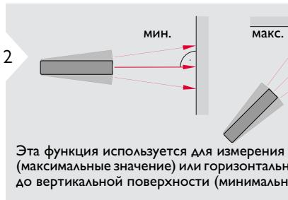
Эта функция используется для измерения диагоналей (максимальные значения) или горизонтальных расстояний до вертикальной поверхности (минимальное значение).
