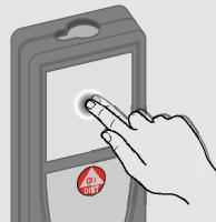
Poklepte na displej pre otvorenie tlačidla na obrazovke alebo na uskutočnenie výberu. Poklepanie na ikonu v strede dolnej línie aktivuje meranie vzdialosti alebo spustí fotoaparát.
