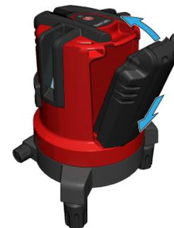
Insérer le bloc de batterie en pressant dessus, puis en l'inclinant vers le logement, conformément à l'illustration, jusqu'à ce qu'il s'encliquète.
