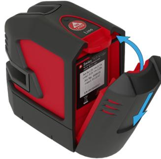
Batteriepaket nach unten einsetzen, dann wie dargestellt bis zum Einrasten gegen das Gehäuse drücken.
