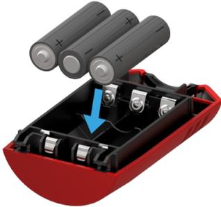
Alkaline Batterien in das Batteriepaket einlegen.
