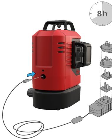
Li-Ion-Akku vor der Inbetriebnahme des Geräts bei +5 °C bis +45 °C (+41 °F bis +113 °F) aufladen. Das Gerät kann sich beim Laden erwärmen. Das ist normal und beeinträchtigt die Lebensdauer oder Leistung des Instruments nicht. Bei einer empfohlenen Lagertemperatur von -20 °C bis +30 °C (-4 °F bis +86 °F) können Batterien mit einer Ladung von 50 % bis 100 % bis zu 1 Jahr gelagert werden. Nach dieser Lagerzeit müssen die Akkus wieder aufgeladen werden.
