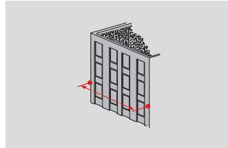
결과가 기본 라인에 표시됩니다. 기능에서 측정 키를 2 초 동안 누르면 자동으로 최소/최대 측정값이 활성화됩니다. 피타고라스는 간접 수평 측정에만 사용하는 것이 좋습니다. 높이 측정(수직)의 경우, 경사 측정이 있는 기능을 사용하는 것이 더 정확합니다.
