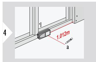
측정을 시작합니다. 측설 라인을 따라 장치를 천천히 이동합니다. 이전/다음 측설점의 거리가 표시됩니다.
