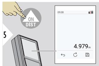
Таймер запускается после нажатия кнопки **ON/DIST**.
