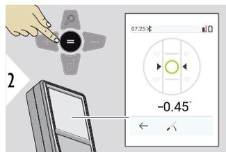
Отображает отклонения на 360°. В положении 0° прибор подает звуковой сигнал. Эта функция идеально подходит для горизонтальной и вертикальной регулировки.
