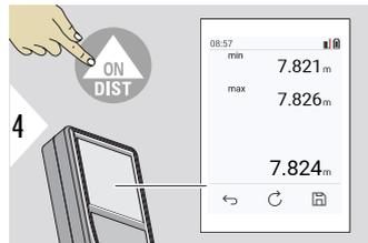
Прекращение непрерывного измерения / измерения минимального/максимального расстояния. Отображаются результаты измерения.
