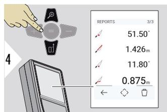
Проверка элементов измерений выбранного отчета.
