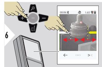
Выберите стрелки с помощью правой кнопки закладок или коснувшись дисплея. Отрегулируйте измерение с помощью кнопок со стрелками или на сенсорном экране.
