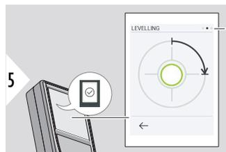
Поверните прибор по часовой стрелке на  $90^\circ$ . Следуйте инструкциям на дисплее.
