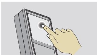
Коснитесь экрана, чтобы нажать на кнопку или сделать выбор. Нажатие на значок посередине нижней линии активирует измерение расстояния или включает камеру.
