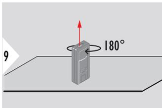
Поверните прибор на  $180^\circ$  по горизонтали и снова поставьте его на абсолютно плоскую поверхность.
