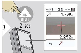
Если для второй заданной точки выбрано постоянное измерение, отображаются значения расстояния, измеренные в режиме реального времени.
