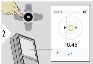
Zobrazí sklony 360°. Prístroj pípne pri 0°. Ideálne pre horizontálne alebo vertikálne nastavenie.
