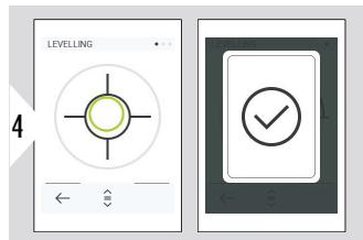
Upravte Leica DST 360-X. Zelená bublina indikuje správne vyrovnanie.
