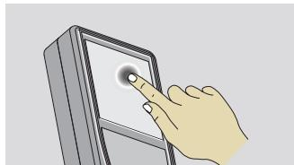
Poklepte na displej pre otvorenie tlačidla na obrazovke alebo na uskutočnenie výberu. Poklepanie na ikonu v strede dolnej línie aktivuje meranie vzdialosti alebo spustí fotoaparát.
