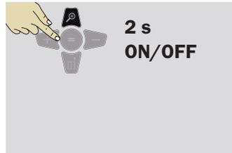
Maintenir enfoncée la touche de zoom pendant 2 s pour allumer/éteindre le viseur. Le paramètre est sauvegardé et reste inchangé, même si l'appareil est éteint et rallumé.
