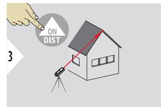
Pointer le laser vers le point supérieur à mesurer.
