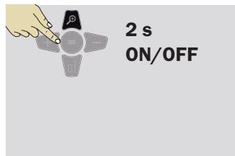
Pritisnite i držite taster za zumiranje 2 s da biste uključili/isključili tražilo. Status se čuva i ostaje isti, čak i da se uređaj isključi i ponovo uključi.
