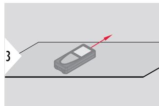
Postavite uređaj na apsolutno ravnu površinu.
