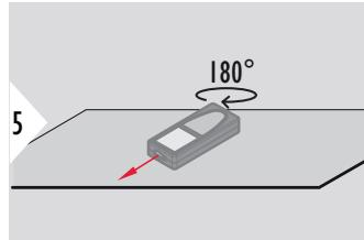
Okrenite uređaj horizontalno za 180° i ponovo ga postavite na apsolutno ravnu površinu.
