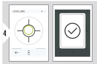
Ajustar el Leica DST 360-X. Una burbuja verde indica una nivelación correcta.
