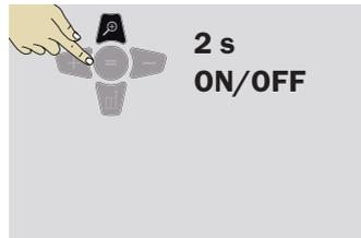
Pulsar y mantener pulsada la tecla de zoom durante 2 s para encender/apagar el visor de punto. El estado se guarda y se conserva incluso si el dispositivo se apaga y se vuelve a encender.
