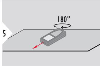
Girar el dispositivo horizontalmente 180° y colocarlo de nuevo sobre una superficie absolutamente plana.
