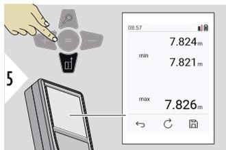
Utilizar la tecla de navegación hacia **abajo** para aplicar valores en la línea principal para enviarlos a través de Bluetooth.
