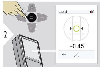
Muestra las inclinaciones de 360°. El instrumento emite un pitido a 0°. Perfecto para ajustes horizontales o verticales.
