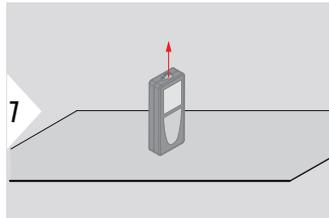
Colocar el dispositivo sobre una superficie absolutamente plana.
