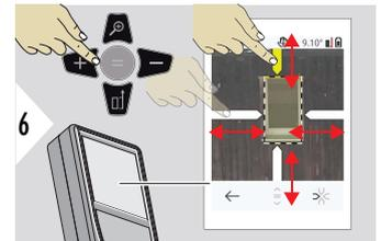
Seleccionar flechas con la tecla de favoritos derecha o pulsando en el display. Realizar el ajuste para la medición con las teclas de flecha o en la pantalla táctil.
