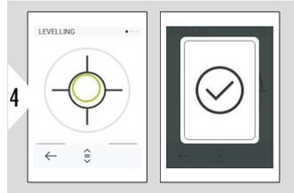
4 Ajustar el Leica DST 360-X. Una burbuja verde indica una nivelación correcta.
