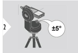
Para nivelarlo, el dispositivo debe estar en un rango de inclinación de  $\pm 5^\circ$ .
