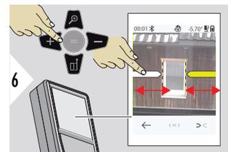
Seleccionar flechas con la tecla de favoritos derecha o pulsando en el display. Realizar el ajuste para la medición con las teclas de flecha o en la pantalla táctil.
