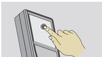
Pulsar en el display para abrir un botón en pantalla o para efectuar una selección. La pulsación en el icono situado en el medio de la línea inferior activa la medición de distancia o enciende la cámara.
